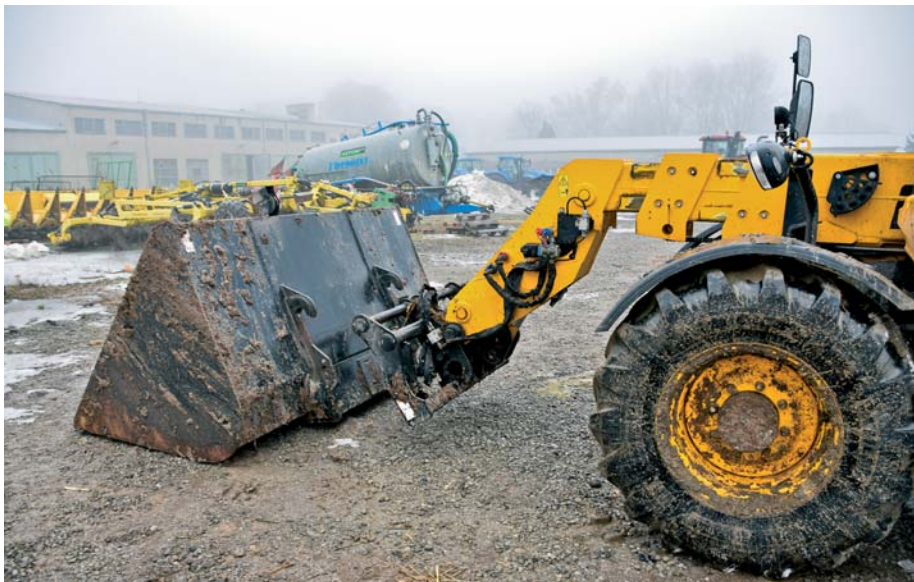
Hydraulické istenie náradia je v základnej výbave.
