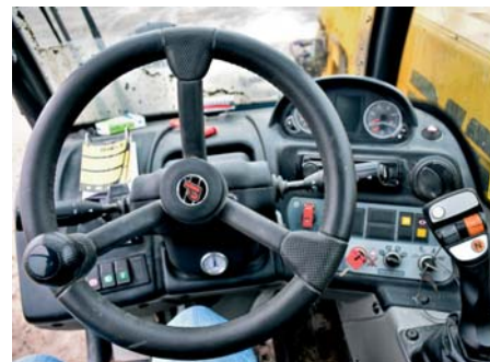
Pohľad na hlavné ovládacie prvky. Joystickom viete reverzovať pohyb stroja.
