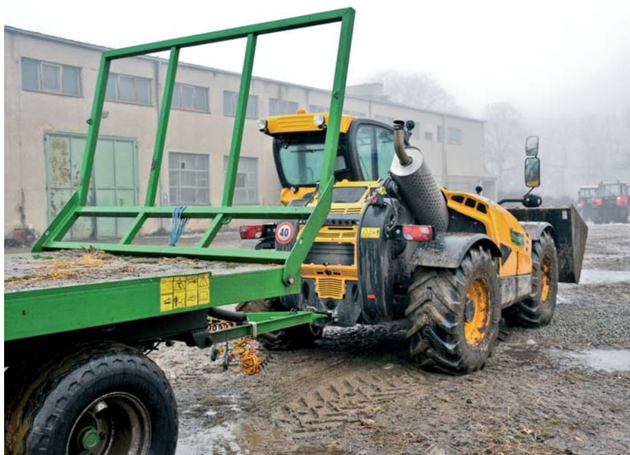
K manipulátoru viete pripojiť 20 t brzdený príves. K sejačke si tak vie pritiahnúť osivo či hnojivo.
