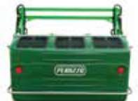
Mulčovač so zberom Peruzzo Koala 1600P pracovný záber 148cm, objem zásobníka: 900 l, vysoké vyklápanie zásobníka do výšky 185cm, kardan 6.490,- €
