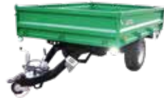
Vlečka Agrobion VHN22 2030 rozmer korby 200x300cm, výška bočnice 48cm, celková hmotnosť 2450kg
