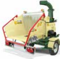
Nesený drvič Negri R260TPLN požadovaný výkon min. 35HP, výkon 10 - 14 m 3 /h, hmotnosť 620kg
