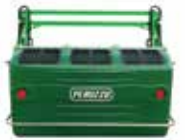
Mulčovač so zberom Peruzzo Koala 1600P pracovný zaber 148cm, objem zásobníka: 900l, vysoké vyklápanie zásobníka do výšky 185cm, kardan
