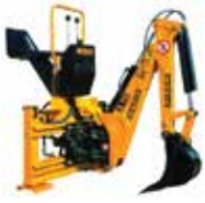
Podkop FEMAC 4.21 pracovný dosah 220cm, hmotnosť 410kg, ťhacia sila 2200kg
