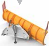
Snežná radlica Agrometall OR-M 2000 šírka radlice 200cm, oporné kolesá, gumový brit
