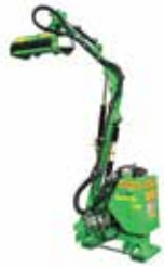
Priekopový mulčovač Frontoni dosah 170cm, pracovný zaber 50cm, lanové vedenie 7.870,- €
