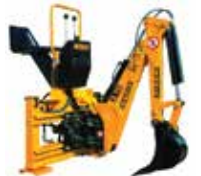
Podkop FEMAC 5.23 pracovný dosah 260cm, hmotnosť 580kg, ťhacia sila 2800kg
