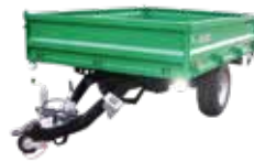
Vlečka Agrobion VHN15 1425 rozmer korby 140x250cm, výška bočnice 48cm, celková hmotnosť 1370kg 4.390,- €
