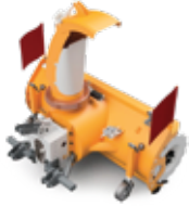
Snežná fréza Agrometall SF 1800 UZ pracovný zaber 180cm, hydraulické natáčanie komína, hydraulické nastavenie klapky, kardan
