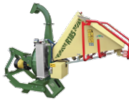
Nesený drvič Negri R185TRIN požadovaný výkon min. 15HP, výkon 6 - 7 m 3 /h, hmotnosť 300kg 7.315,- €
